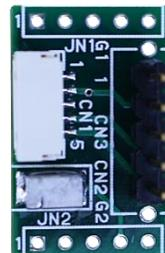
乾式筋電センサーのケーブル先端に接続されているコネクタ (GHR-05V-S) とリファレンス電極バンドのケーブル先端に接続されているコネクタ (HJ-3) を接続可能とするプリント基板です。また、5Pヘッダー (CN3) およびスルーホール (JN1、JN2) より乾式筋電センサーへの電源供給、筋電出力信号の中継が可能です。
